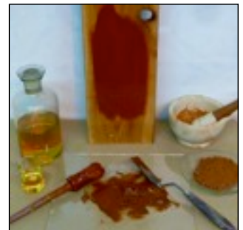
Leinölfarbe entsteht durch das Verreiben des konservierenden Bindemittels gekochtes Leinöl mit dem Farbmittel Erdfarbe oder Pigment. 0,1 bis 3 % Trockenstoffe werden hinzugefügt.
